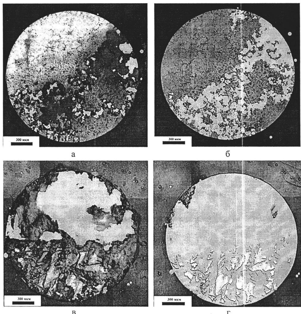
Рисунок 3 – Области измерения объёма металла потерянного в результате коррозии (закрашены розовым): а – после выдержки в 0,9NaCl, б – после удаления продуктов коррозии, а, б – сплав AZ81, в, г – сплав MgPure
