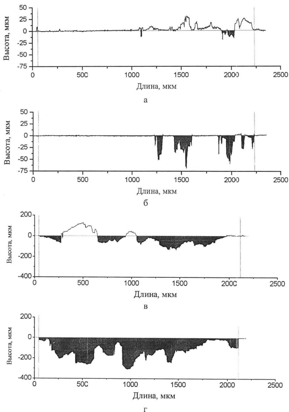
Рисунок 2 – Методика определения объёма металла, потерянного в результате коррозии: а, в – после выдержки в 0,9NaCl, б, г – после удаления продуктов коррозии, а, б – сплав AZ81, в, г – сплав MgPure
