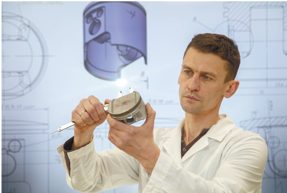
■ Разработанный в ТГУ поршень из жаропрочного магниевого сплава может использоваться в двигателях мототехники и беспилотников
