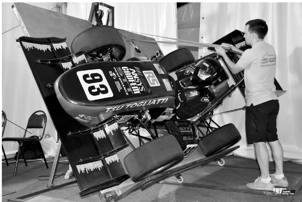
■ «Скорпион» проходит тест на опрокидывание
