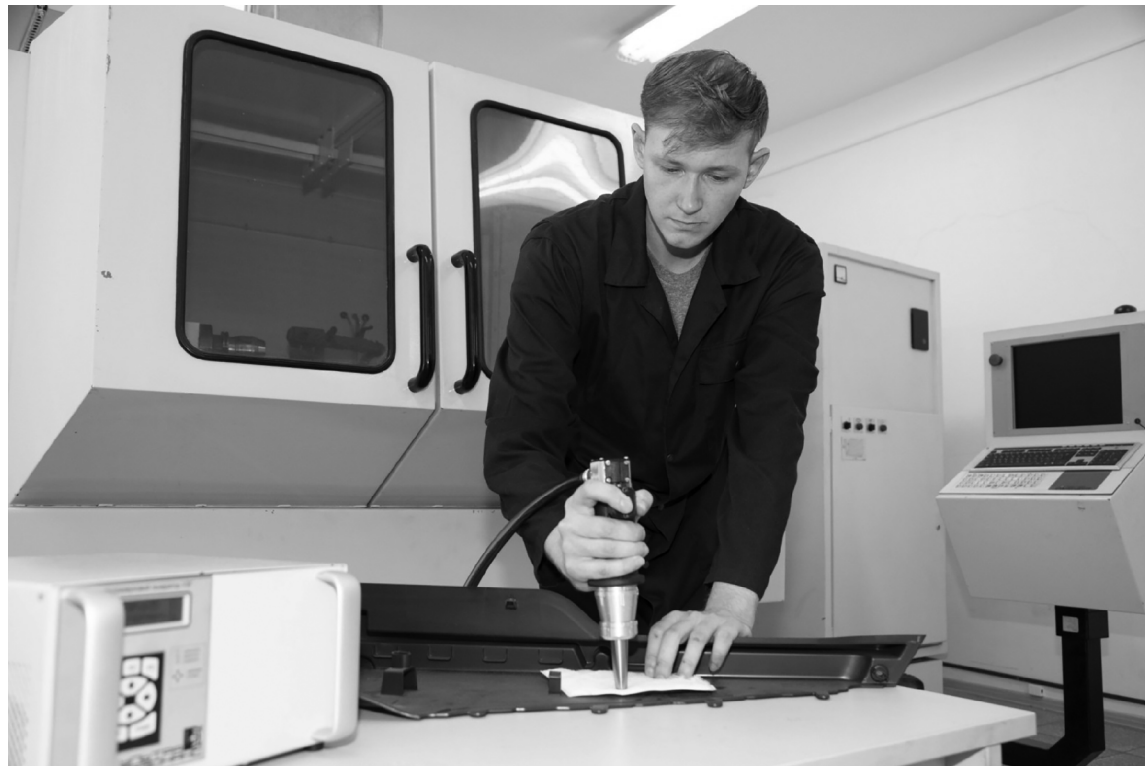
■ Магистрант ТГУ Николай Спиридонов оформил авторские права на конструкцию устройства для ультразвуковой сварки полимерных материалов
