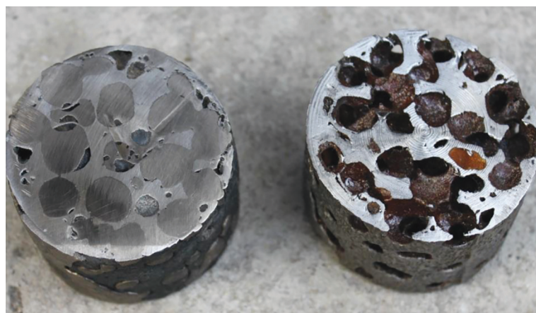
■ Композиционный материал сталь-алюминид железа
